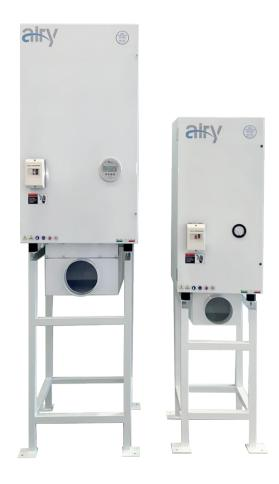
Tutti gli elementi filtranti sono posizionati all'interno della struttura e inseriti in apposite guide che rendono facile lo smontaggio per sostituzione e manutenzione.
